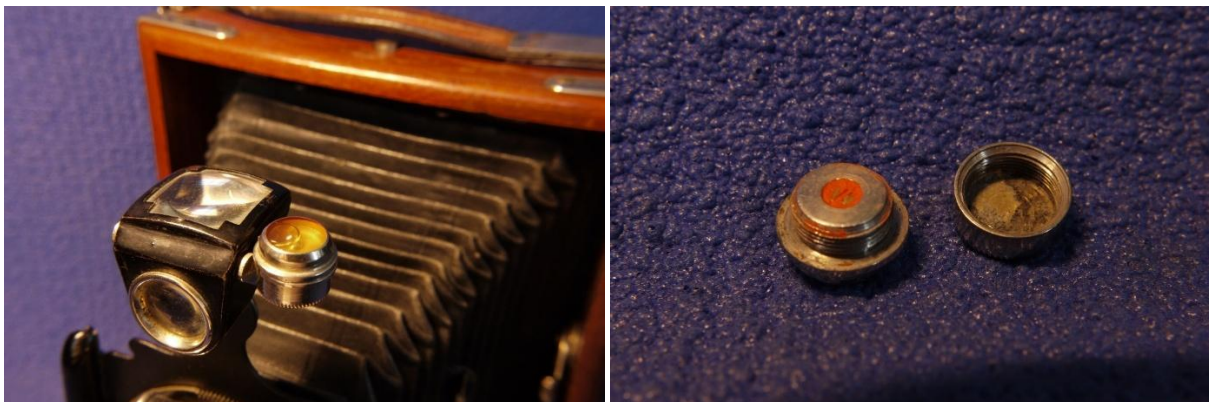
Dosenlibelle alter Bauart mit der Befüllungsschraube mittig:
