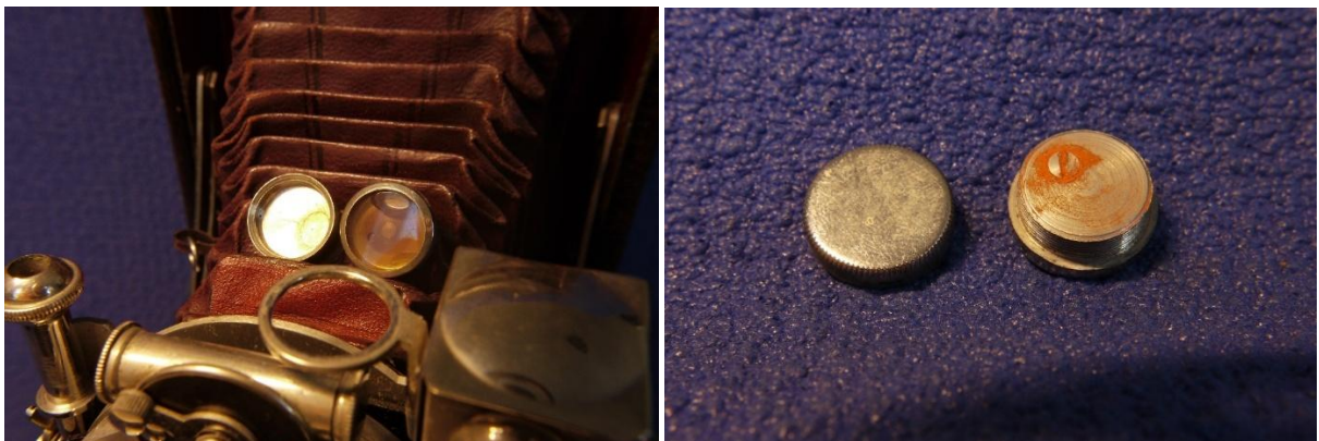
Dosenlibelle alter Bauart mit der Befüllungsschraube mittig:
